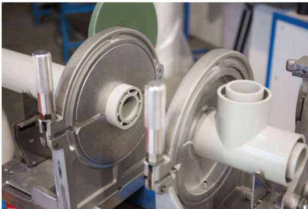
El sistema de tuberías dobles Poly-Flo de AGRU puede unirse de forma rápida mediante soldadura simultánea.
