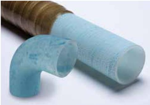
El revestimiento HV para PVDF de AGRU es una alternativa económica a los tubos laminados clásicos. La superficie tratada del tubo de PVDF presenta una estructura tridimensional que garantiza una adherencia óptima al tubo de GFK. Los sistemas de tuberías están disponibles en los materiales PVDF, PVDF-FLEX y PVDF-el. Se pueden fabricar tubos de entre 20 y 400 mm.
